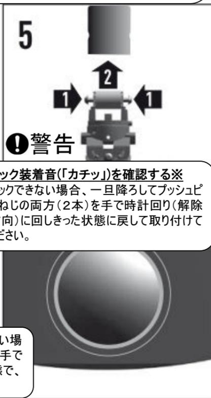
取付け前に、ねじを回すとロックできない場合があります。押しピンねじ(2本)を手で時計回り(解除方向)に回しきった状態で、取り付けてください。
