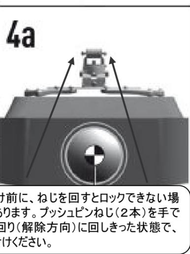
取付け前に、ねじを回すとロックできない場合があります。プッシュピンねじ(2本)を手で時計回り(解除方向)に回しきった状態で、取り付けください。
