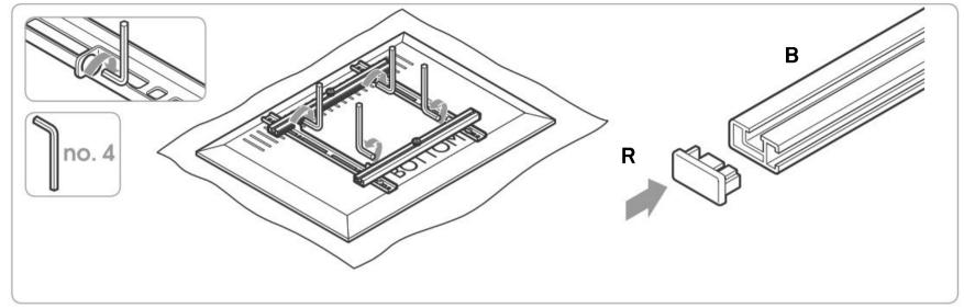
取付金具(C)のボルトを締めてバー(B)を固定してください。 キャップ(R)をバー(B)に取り付けてください。
