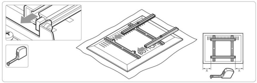
バー(B)を取付金具(C)上でスライドさせて等間隔になるよう組み付けてください。 ディスプレイ接続端子がバー(B)に重ならないようにしてください。
