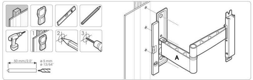
ウォールマウント(A)の壁設置用穴に合わせて壁に穴を開けて下さい。(柱及び補強材のある場所に穴を開けて下さい)
