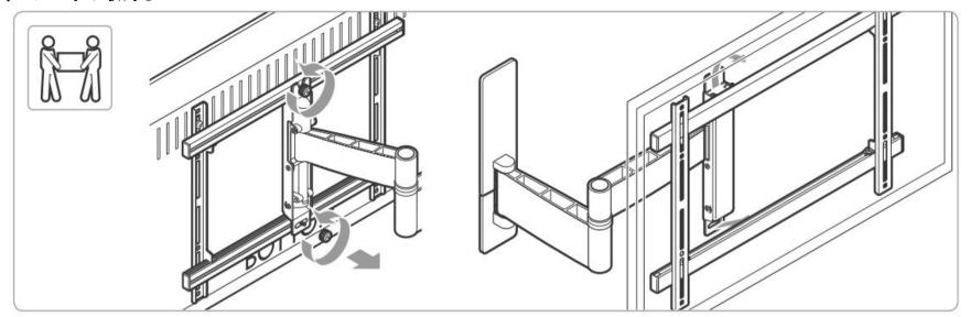
バー(B)の上部のねじを緩め、下部のねじを外して、ディスプレイを取外してください。
