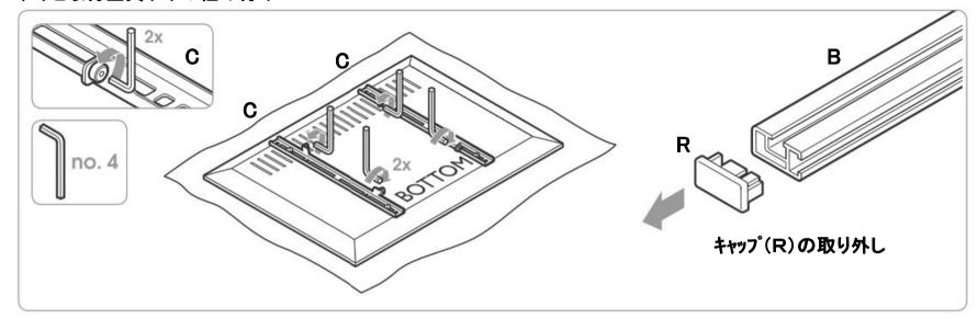
取付金具(C)のボルトを緩める。 バー(B)からキャップ(R)を取外す。
