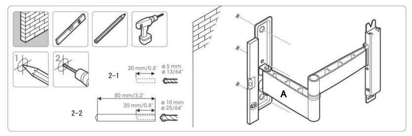
ウォールマウント(A)の壁設置用穴に合わせて壁に穴を開けてください。(壁破損を防ぐため 2-1.下穴を開けてから 2-2.本穴を開けて下さい)
