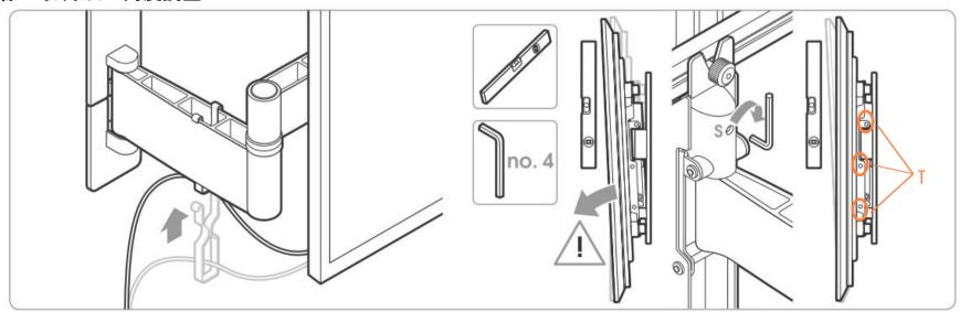
ケーブルを挟まないように、配線用金具を使って配線してください。 ディスプレイの角度調整:0°及び 20°の位置で固定できます(中間位置では固定できません)
