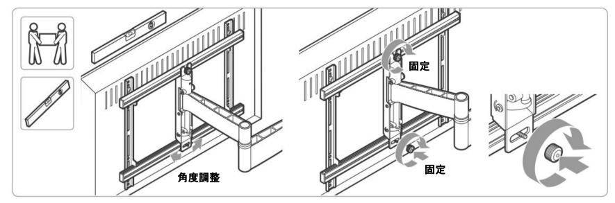
ディスプレイが水平になるように、角度調整し、上下のねじを固定してください。
