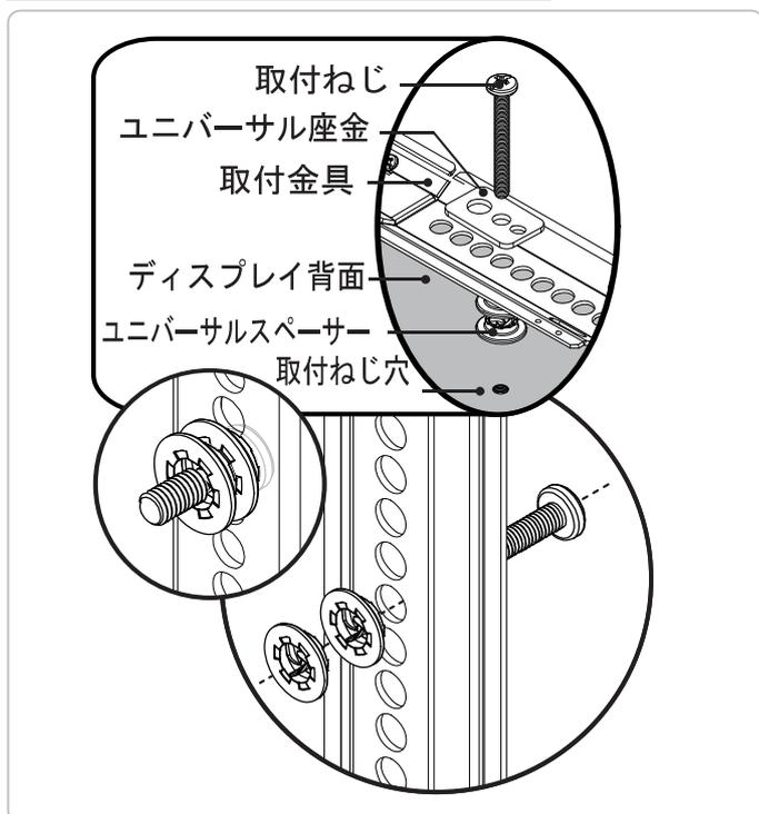
取付ねじ付近に凹凸がある場合でも、ユニバーサルスペーサーを使用して、取付金具を固定することができます。
