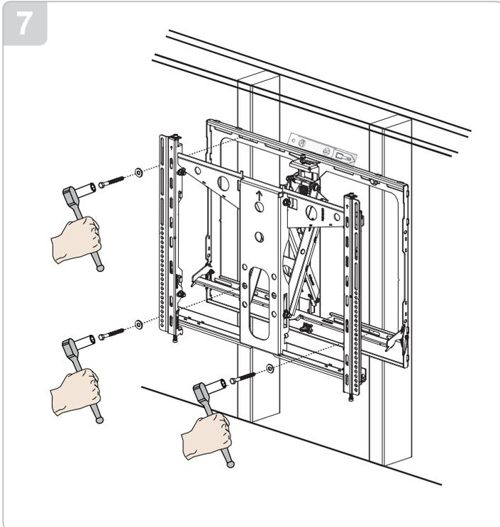
1) 六角タッピングボルト (8×75) と平座金 (呼び8) で固定します。
