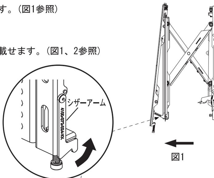
この機能は、ディスプレイをマルチに設置している際のメンテナンス時にご使用ください。メンテナンス後は必ずシザーアームを元の位置に戻し、落下防止ねじを締めてください。
